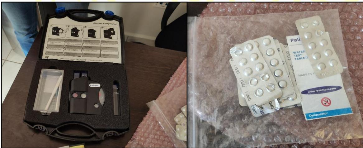
Figura 12 Equipo portátil para el monitoreo de cloro residual
